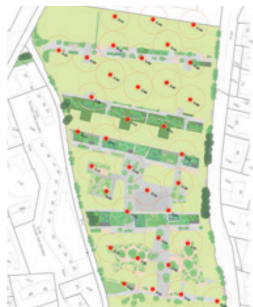
Plan des Plaines-du-Loup et disposition des 35 sondes géothermiques (points rouges).
